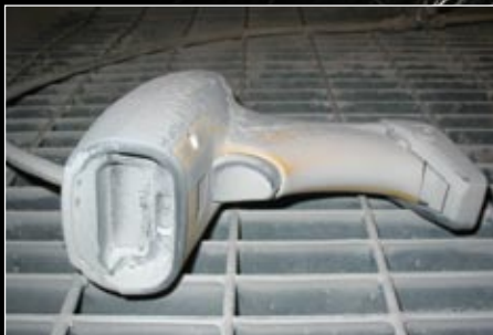
Test di penetrazione di polvere/particelle - Equivalente a 5-7 anni di uso industriale
