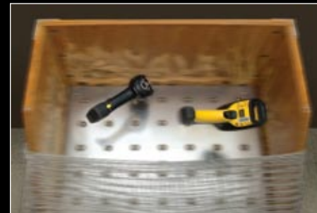
Prueba de Estrés por Carga Suelta: 10 horas de caídas al azar contra superficies de metal.
