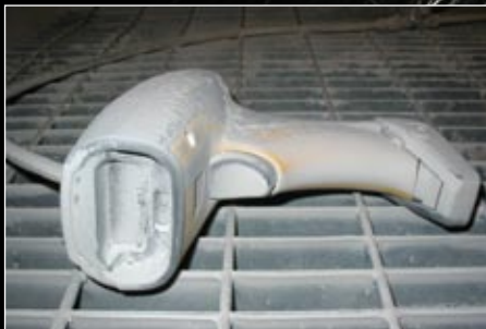
Prueba de Penetración de Polvo y/o Partículas: equivalente a 5 a 7 años de uso industrial.
