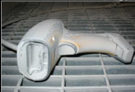
Staub/Partikeleindringungstest: entspricht etwa 5-7-jährigem Industrieinsatz
