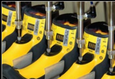
Prueba de Gatillo: se probó hasta 10 millones de ciclos.
